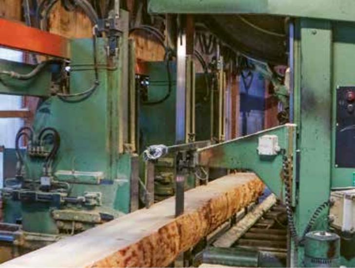
Einschnitt Rundholz. Der Einschnitt mit der Bandsäge ist sehr flexibel und ermöglicht so eine optimale Ausnutzung jedes Stamms.
